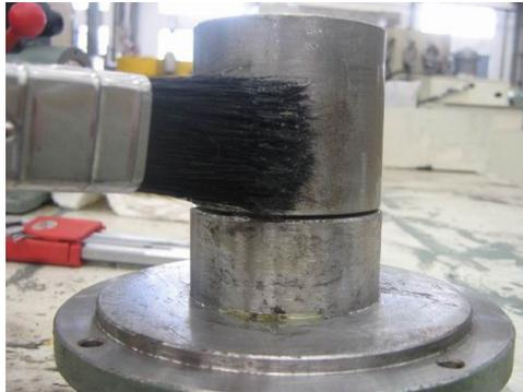
将撞帽往里推使动静铁芯处存在间隙，用刷子在推杆上加入齿轮油。
