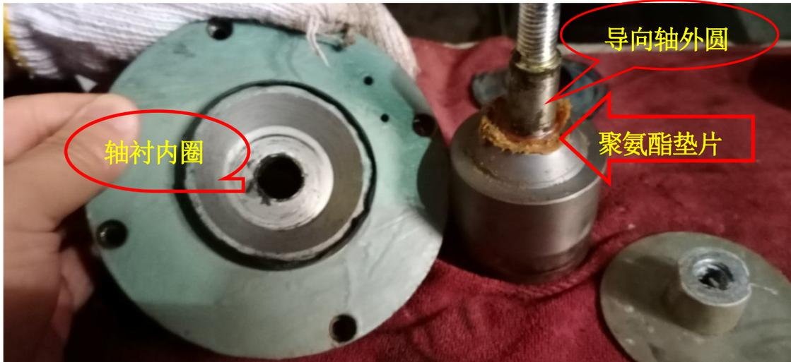
4.4.7 检查聚氨酯垫片是否有破损或老化（如有破损或老化，需及时更换为新品），
