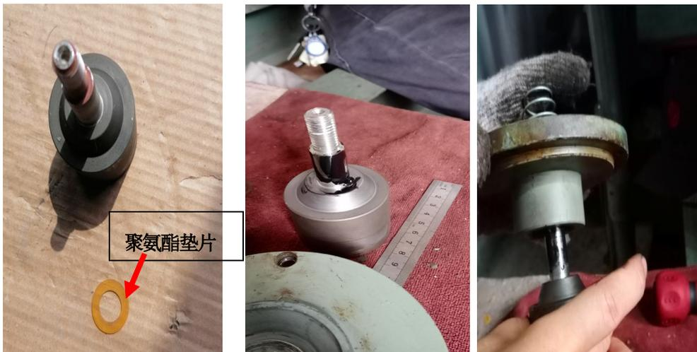
4.4.8 依次装入弹簧和锁紧螺母、装入防尘胶套，将动铁芯固定。
