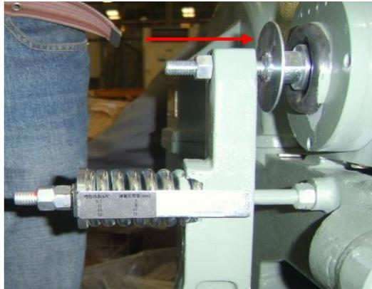
4.3.2 如可正常滑动，使用开口扳手将两对锁螺母逆时针旋松，释放弹簧压缩力，将两螺母对锁紧；再将固定螺杆的螺母松开，然后将对锁螺母逆时针旋松，直到将螺杆松脱—参见下图。
