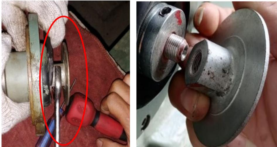
4.4.4 用M4内六角扳手拆卸固定制动器端盖的四个螺丝旋松后取下端盖。
