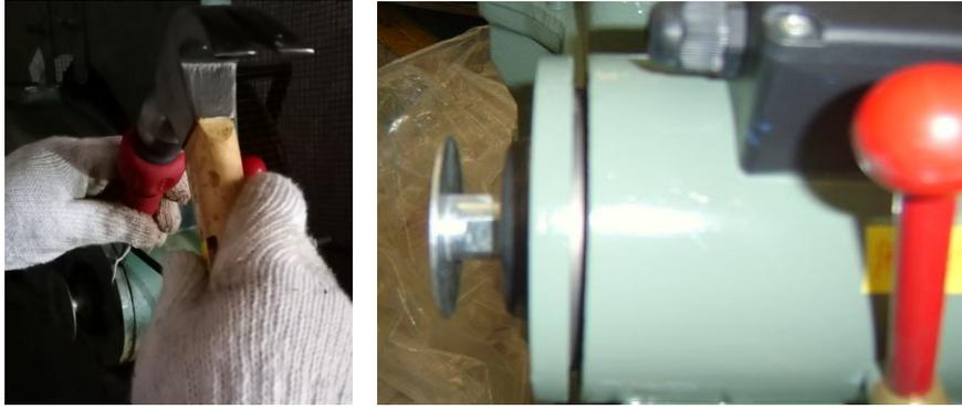
4.4.5 将螺杆上的螺纹紧固剂残渣清除，将动铁芯固定，用勾型扳手将锁紧螺帽旋松，拆下锁紧螺母及弹簧。
